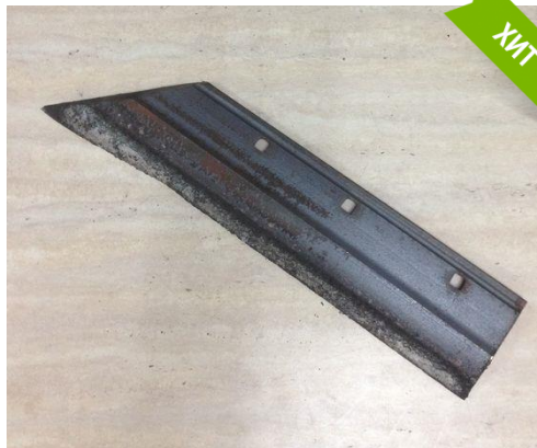
РЗЗ-ПЛЖ-31-702 Лемех с заточкой и наплавкой (лемешная полоса, сталь Л-53) 590 руб.
