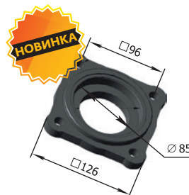
Крышка корпуса подшипника Р33.БДЛ-322 М=1,09 кг
