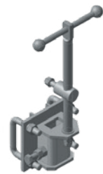
Механизм подъема в сборе Р33.06.300 М=12,7 кг
